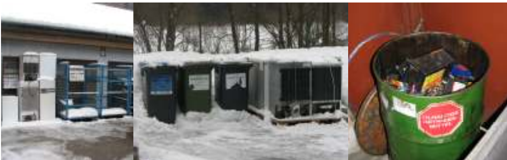
Die Lagerung von Kühlgeräten ohne Überdachung im Freien ist besonders in den Wintermonaten sehr problematisch. Gerätealtbatterien in Metallfässern ohne Folieneinsatz erhöhen die Gefahr von Funkenbildung.
